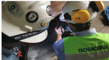
Análisis no destructivos en sitio para identificar aleaciones, durezas, espesores y tasas de desgaste.
