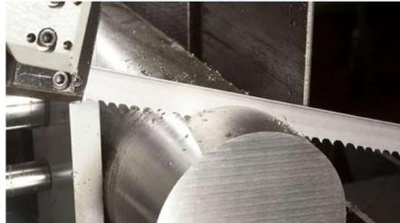
Corte de materiales redondos, cuadrados o rectangulares de hasta 500mm de diámetro y 200mm de espesor.
